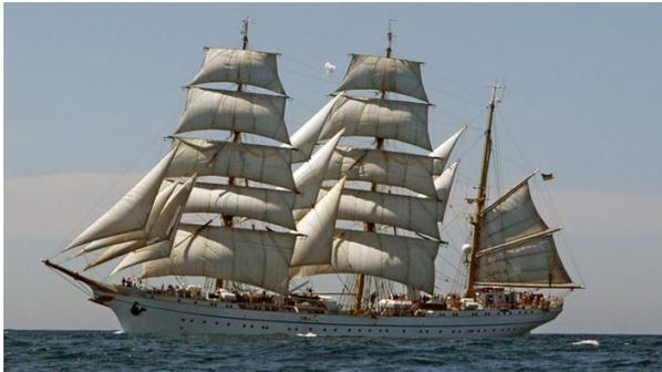
*Bark: Ein Frachtensegler mit 3 Masten, Gaffel- und Schratsegel an Bug und Heck und die Rahsegel an den 3 Masten quer zum Schiff*
