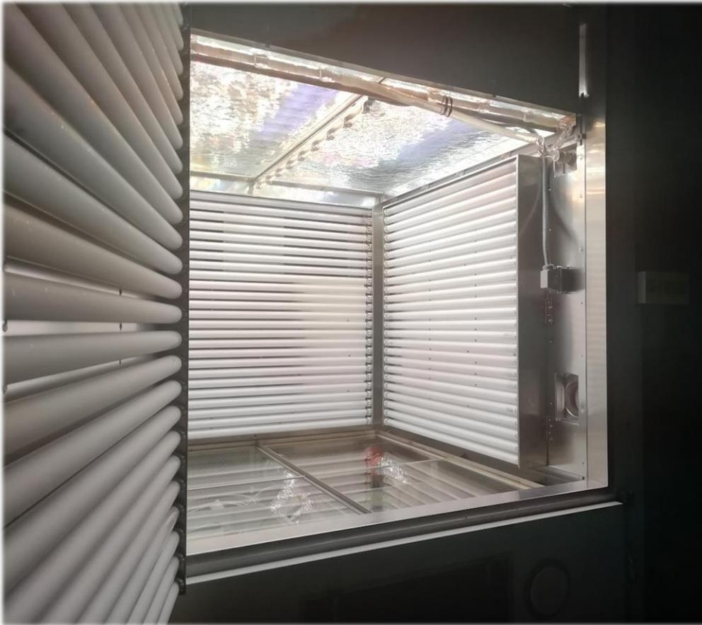
*Abbildung 32: Eine der kleineren Expositionsammern. Oben sieht man den Wasserfilter auf Glas, an den Seitenwänden UV-B Röhren. Unter dem Glas unten können Pflanzen und andere Proben positioniert werden.*
