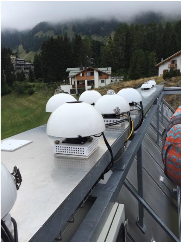
Abbildung 9: Pyranometer auf dem Dach
