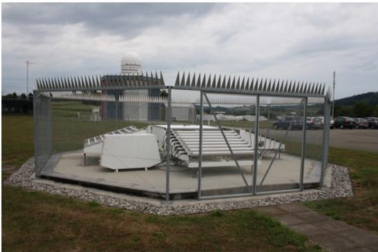
Abbildung 28: Windprofiler
